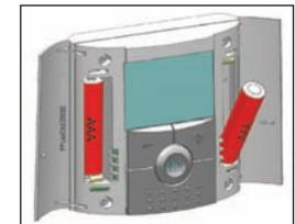
7. Отсоедините пластиковую прокладку одной из батарей
