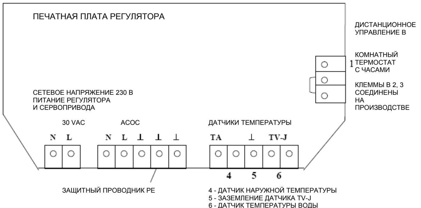
Рис. 2. Схема подключения клемм
