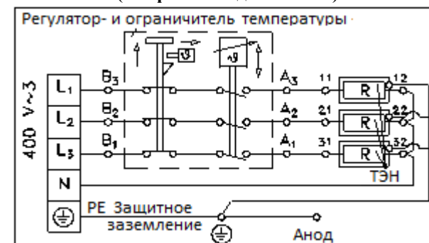
Схема подключения нижнего ТЭН-а (3-х фазное подключение)
