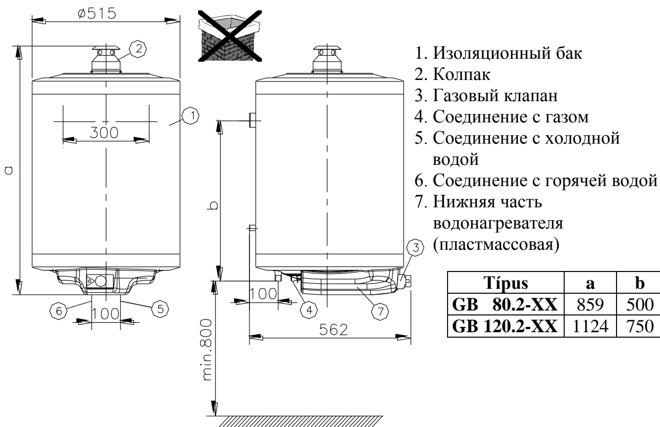
Схема № 1.2.: Общий вид с габаритными размерами
