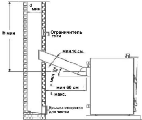
Рис. 6 Пример подключения к дымоходу
