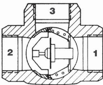
Терморегулирующий вентиль «ESBE» типа «TV 60°C» используется в котлах, работающих на твёрдом топливе. При температуре воды в котле + 60°C откроется терморегулирующий вентиль, и в котловый контур (3→1) поступит жидкость из контура отапливаемого объекта (2). Приводы 1 и 3 постоянно открыты. Таким образом обеспечена минимальная температура возвратной воды в котле. В случае необходимости можно использовать терморегулирующий вентиль, наставленный на более высокую температуру (например, 72°C).
