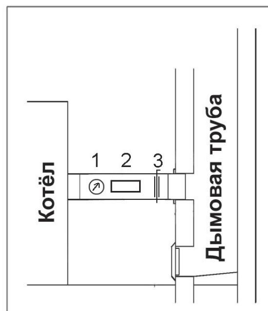
1. Термометр топочных газов
