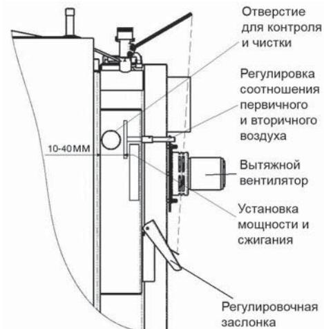
**Для котлов с вытяжным вентилятором «C50S»****Начальная установка первичного воздуха**
