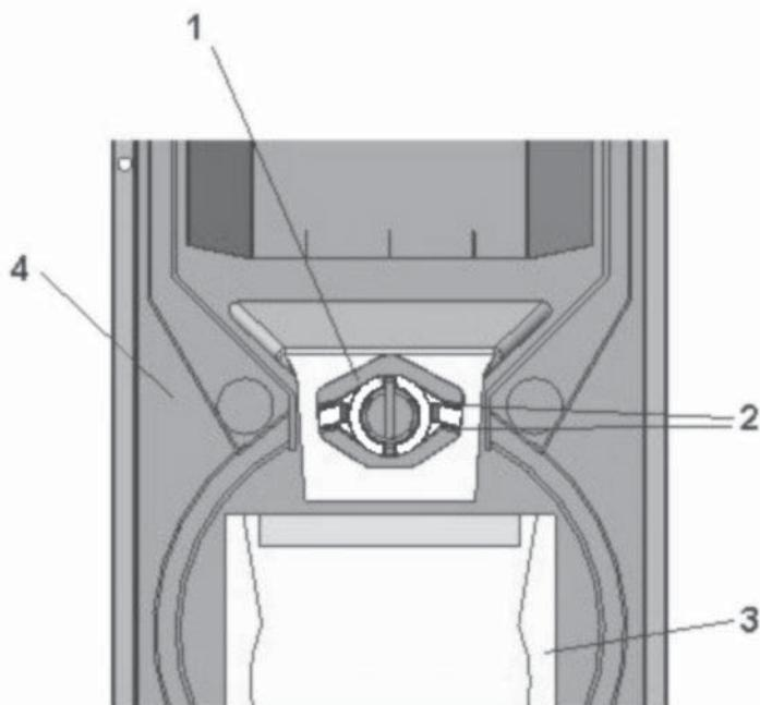
Установка колосниковых сегментов изображена на рисунке и одинакова как для сжигания угля, так и древесины. Каналы привода вторичного воздуха должны быть всегда направлены вниз.
